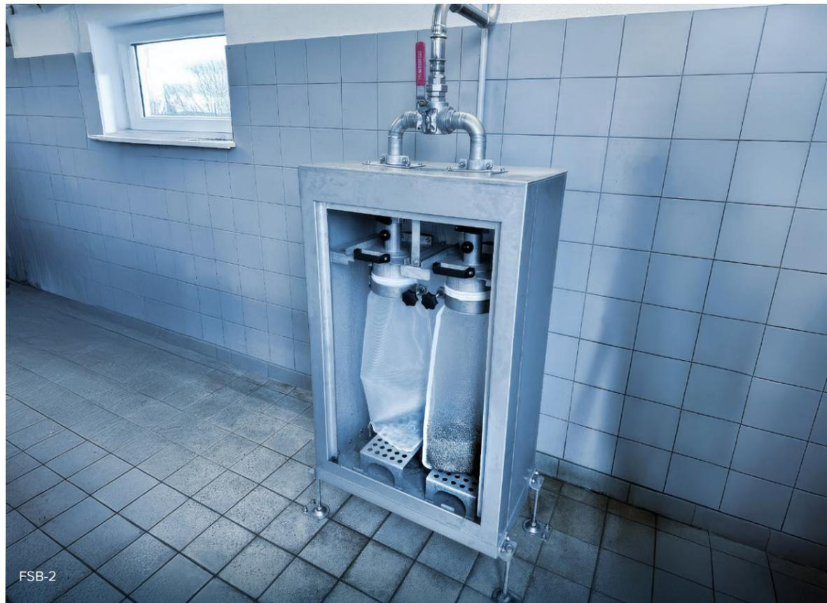
Der Fettsammelbehälter FSB-2 ist ein innovativer Zweikammer-Abscheider, der speziell für das statische Entwässern von Fett- und Schwimmstoffpartikeln entwickelt wurde. Mit diesem Gerät können Sie Fett und Schwimmstoffe effizient vom Abwasser trennen und sammeln. Die Qualität des abfließenden Filtratwassers ist nahezu feststofffrei.
